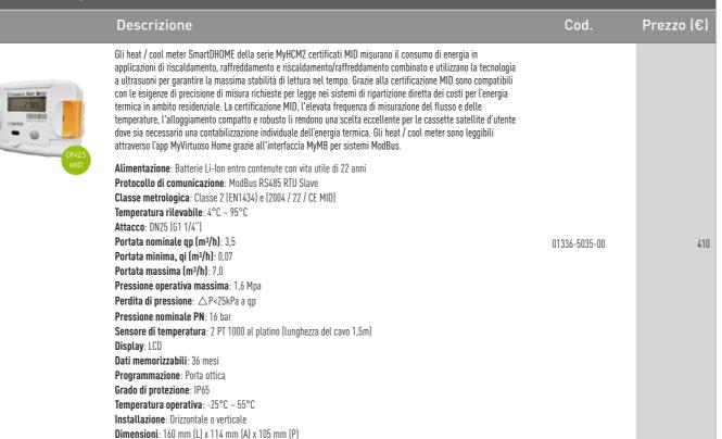
Contatore di energia termica (Heat/Cool) a ultrasuoni MyHCM2 DN32 portata media 6,0 m³/h con interfaccia Modbus e certificato MID
