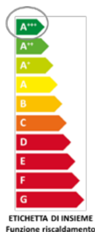
Fig. 9 – Scala di efficienza: etichetta di insieme: combinazione di apparecchiature di riscaldamento d'ambiente.
