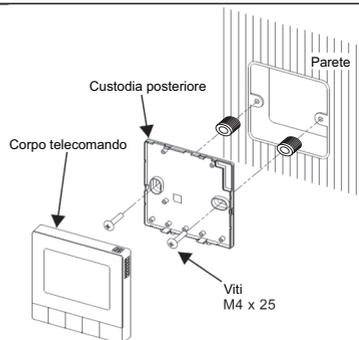
1. Inserire un cacciavite a taglio o oggetti simili nella scanalatura sul lato inferiore del corpo telecomando, e girare per rimuovere
