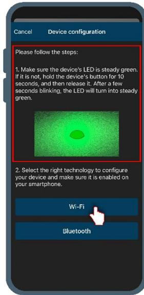
Figure 11.- Wi-Fi configuration – Wi-Fi.
