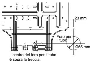
1. Dopo aver determinato la posizione del foro per il tubo con la lastra di installazione (➔), trapanare il foro per il tubo (Ø65 mm) con una leggera inclinazione a scendere verso l'esterno.
