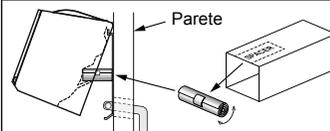
Tagliare un pezzo di SPACER dalla confezione dell'unità interna, arrotolarlo e inserirlo tra l'unità interna e la parete al fine di inclinare l'unità interna per un funzionamento più efficiente.
